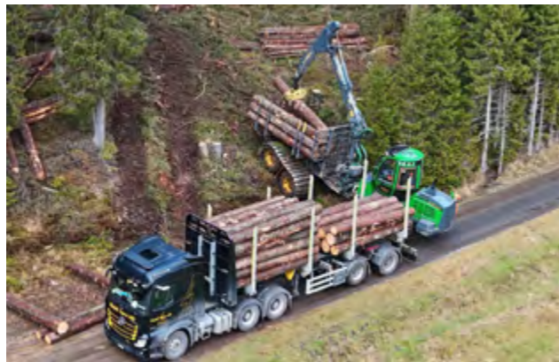
Direktverlad auf LKW mit Forwarder
